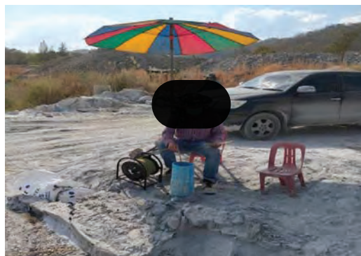
รูปที่ 20 การวัดระดับน้ำขณะทำการทดสอบหาความรั่วซึมของน้ำด้วยวิธี Slug Test
