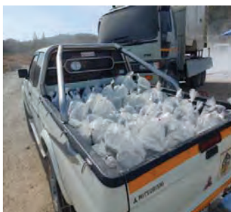
การเก็บตัวอย่างเศษดินและสะเก็ดหิน (Cutting sample) จากหลุมเจาะสำรวจ
